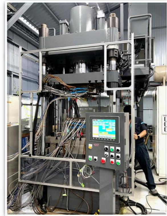
CF RTP プレス成形用試験機（郷製作所）
