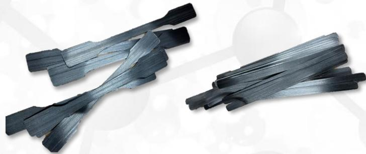
引張試験および曲げ試験用プリプレグ
