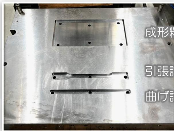
成形精度評価試験片
