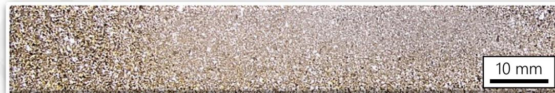
スーパーインバー合金における (a) 鋳造時に形成する粗大な柱状結晶組織および (b) 鍛造プロセスによる結晶粒の微細化
