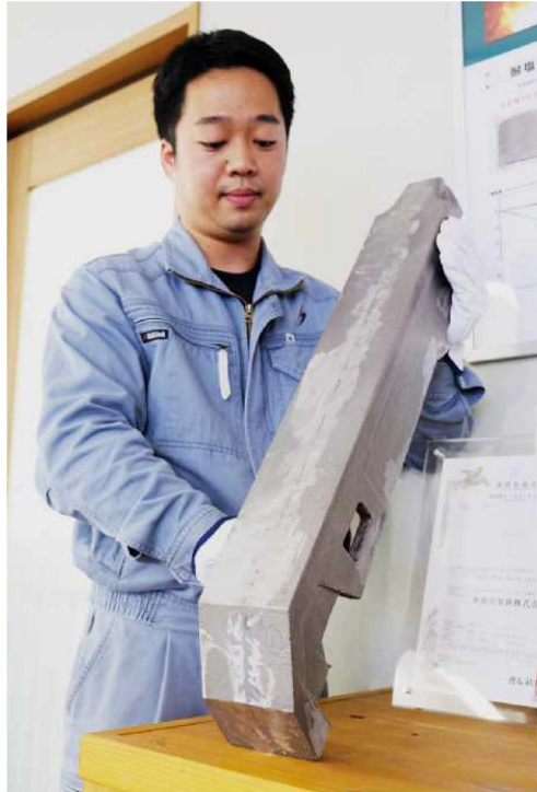
ゴミ焼却炉向け耐塩素・耐腐食合金「EGNIS(イグニス)」
