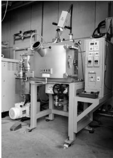
新報国マテリアルが導入した真空アーク溶解炉（ボタン溶解炉）
