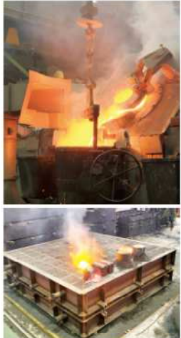
溶解炉の出鋼の様子(左)注湯後の鋳型
