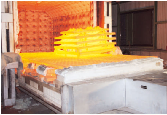
精緻な成分調整や熱処理の制御で高温域の熱膨張特性を高めた（三重工場の熱処理工程）
