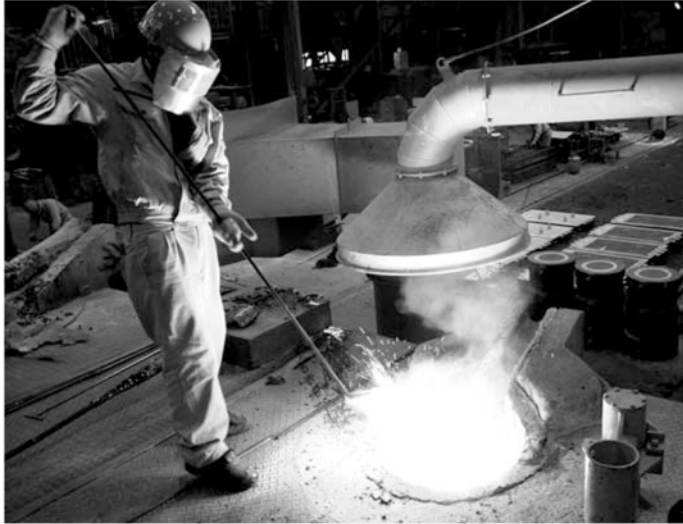
2ト炉の追加で能力だけでなく生産効率も向上する（溶解工程）
