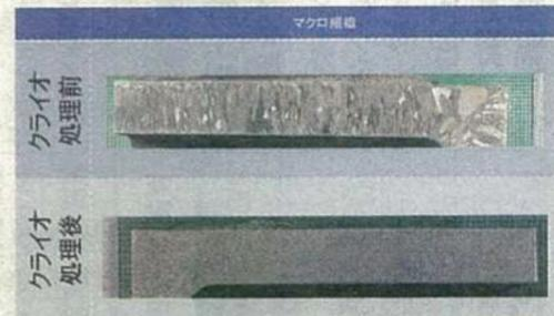
独自の技術・研究ノウハウを駆使して、通常のインバー(低熱膨張合金)鋼物よりも剛性を30%高めた高剛性インバー鋼物の開発を成功させた。液体窒素を用いるクライオ処理(深冷処理)により、ヤング率140GPa(ギガパスカル)以上の「IC-EX1」を開発し、さらには独自製法の組み合わせて、熱膨張ゼロの高剛性インバー鋼物
